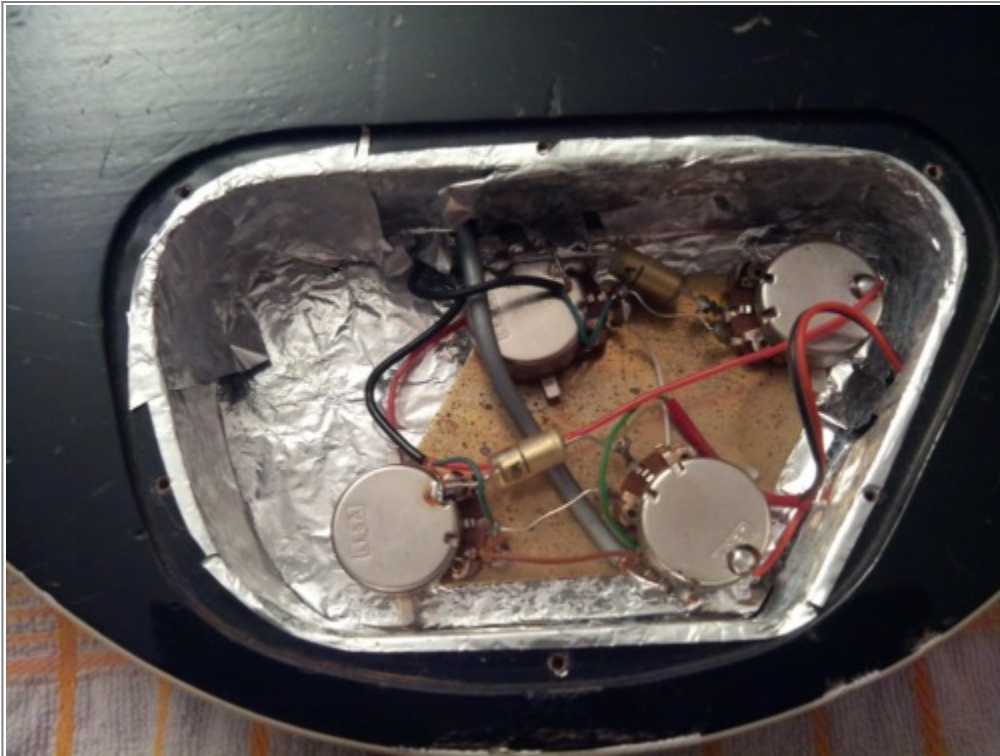
Les condensateurs originaux encore en place.
