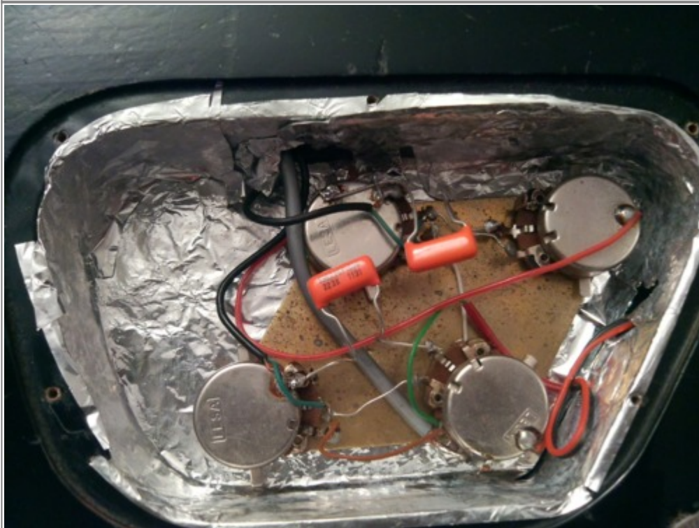
Les nouveaux condensateurs installés.
