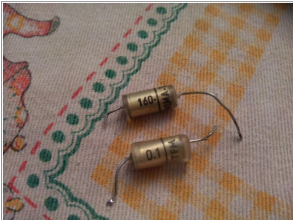
Gros plan sur les condensateurs originaux.
