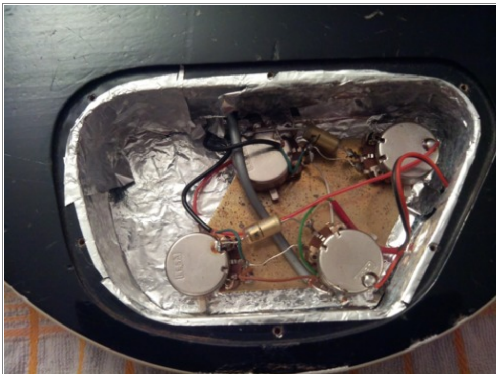
Les condensateurs originaux encore en place.
