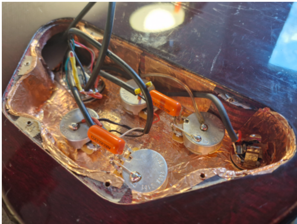
Le circuit électrique de la SG CMI, complètement changé par le luthier Nugz, en 2025
